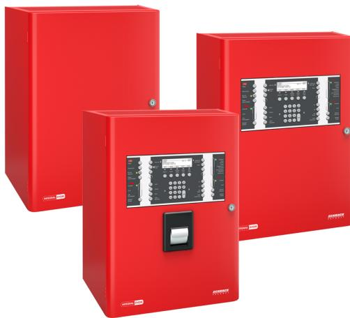
■ vollredundante, modulare Zentrale mit dezentralem Systemaufbau ■ bis zu 16 Loops je Zentrale ■ vernetzbar über Kupfer- oder Glasfaserverbindung ■ Ereignisspeicher für bis zu 65 000 Meldungen ■ frei programmierbaren Steuerungen und Algorithmen ■ Möglichkeit zur Fernüberwachung über Internet ■ diverse Protokolle zur Anschaltung an Gebäudeleitsysteme ■ integrierte LAN-Schnittstelle ■ drahtlose Serviceschnittstelle
