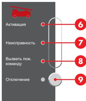
Индикатор **Активация** **6** мигает, если устройство передачи сигнала активировано и местная приемная станция мониторинга уже приняла сигнал тревоги.
