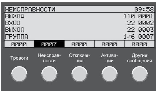
При нажатии кнопок **19** – **22** отображаются списки тревог, неисправностей, отключений или активаций элементов системы. Нажатие кнопки **23** позволяет показать и сделать выбор списков других состояний элементов системы (например, активаций входов, предупреждений извещателей, включений задержек, и т.д.).
