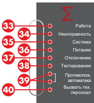
Индикатор **Работа** **33** указывает на текущее рабочее состояние системы. Индикатор не светится в случае выхода из строя основного и резервного источников электропитания.
