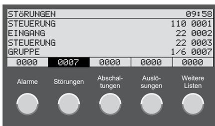
Drücken der Tasten **19** – **22** zeigt im Display die Listen der Elemente mit Alarm- oder Störungsmeldungen, der abgeschalteten Elemente oder der Elemente mit Auslösungen.
