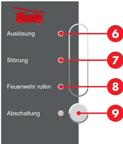
Die LED **Auslösung** 6 blinkt, wenn die Übertragungseinrichtung aktiviert ist, das heißt die hilfeleistende Stelle wurde gerufen.
