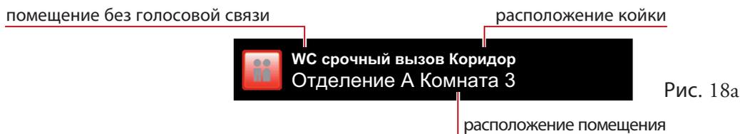
При касании записи такого вызова открывается дополнительное меню (Рис. 18b). При этом генерируется предупреждающий звуковой сигнал.
