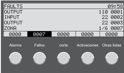
Si una lista contiene entradas, la pantalla correspondiente se mostrará de forma inversa y se indicará el número de entradas. Pulse los botones **19** – **23** correspondientes para mostrar las entradas de la lista. Si no se pulsa ningún botón durante un período prolongado de tiempo, la pantalla volverá automáticamente a la lista con la prioridad más alta (por ejemplo, alarmas). Más información: [Capítulo Alarmas, fallos y listas adicionales, Página 21](#)
