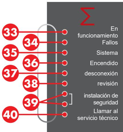
El led **En funcionamiento** 33 indica el estado operativo actual del sistema. El led no se enciende en caso de fallo de alimentación, fallo del panel de control o la acústica del panel de control desactivada.
