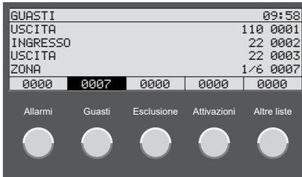
Premendo i pulsanti **19** - **22**, sul display vengono visualizzati gli elenchi di elementi con i messaggi di allarme o di errore, gli elementi disabilitati o quelli con attuazioni. Premendo il pulsante **23** vengono visualizzati gli elenchi aggiuntivi (attivazioni, livelli temporali, pre-segnali o conferme degli errori).
