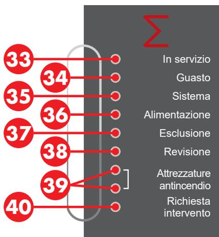
Il LED **In servizio** 33 indica lo stato operativo attuale del sistema. Il LED non si accende in caso di interruzione dell'alimentazione, di guasto del pannello di controllo e di acustica del pannello di controllo disattivata.
