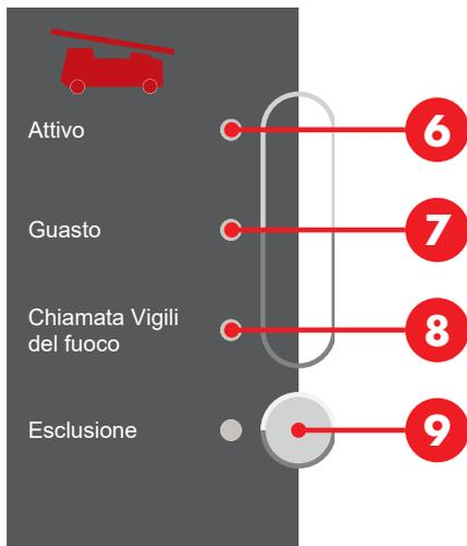
Il LED **Attivo** **6** lampeggia se l'apparecchiatura di trasmissione è attiva, ovvero se è già stata contattata una sede di soccorso.
