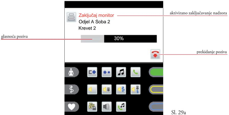
Zaključavanje nadzora se automatski aktivira na početku svakog poziva tako da se pojedinačne pozicije kreveta ne mogu nadzirati. Pritiskanje crvene tipke za pozivanje na dotičnom pacijentovom terminalu otkazuje ovo zaključavanje tako da postoji puna glasovna komunikacija (Sl. 29b).
